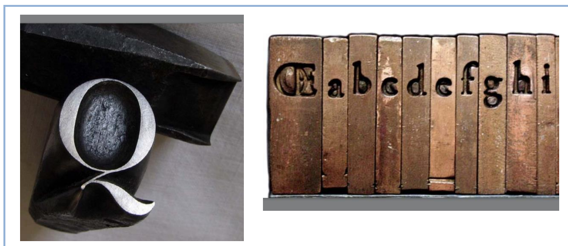
Quadro 12 – Punção para a letra Q da Cannon Roman de John Baskerville e matrizes alinhadas. [Fonte adaptada: HEITLINGER, 2014]
